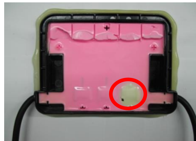
バイパスダイオードの発熱による封止材の変色
